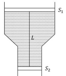
3. Невесомые поршни вставлены в сосуд переменной сечения и связаны идеальной нитью. Площади поршней  $S_1$  и  $S_2$ , длина нити  $L$ . Между поршнями находится вода плотностью  $\rho$ . Определите силу натяжения нити. Трением поршней о стенки сосуда пренебречь.
